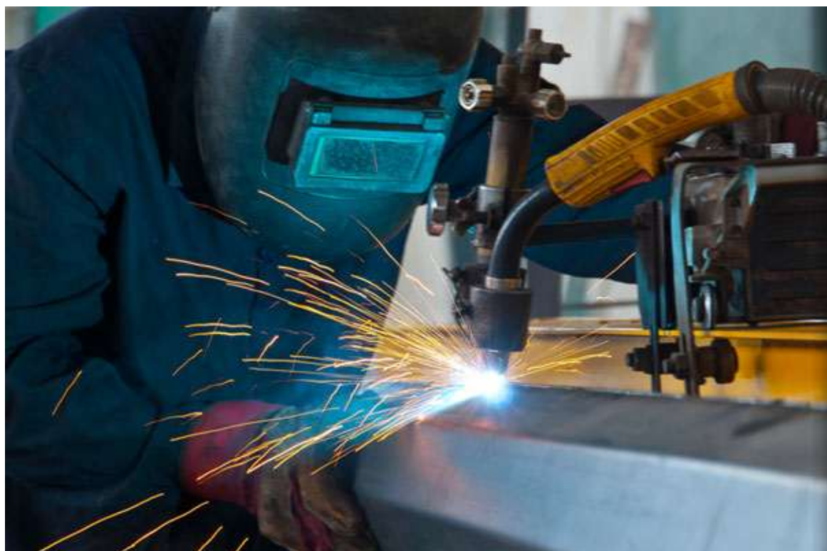
پر کردن درز به کمک جوش
